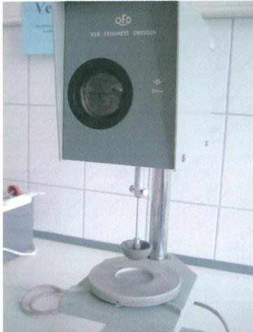
Abbildung 10: Penetrometer
