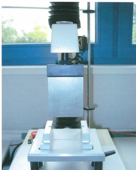
Abbildung 12: Texturanalyser (Guillotine)
