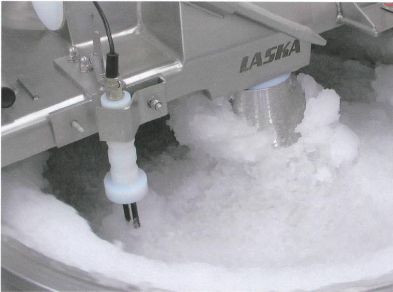
Abbildung 9: Im Kutter eingebaute Elektroden zur Leitfähigkeitsmessung
