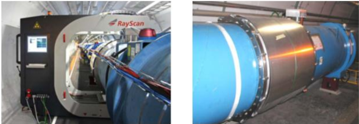
Abbildung 11: Der Röntgentomograph RayScan Mobile im Betrieb am LHC (links) und Verbindungszone (rechts) [16]
