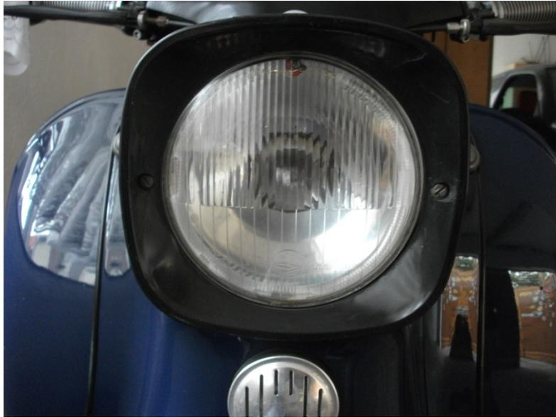
Abb. 8: Bilux-Scheinwerfer von einer Simson Schwalbe KR51/2L
