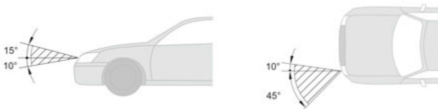
Abb. 2: geometrische Sichtbarkeit des Abblendlichtes eines Kraftfahrzeuges
