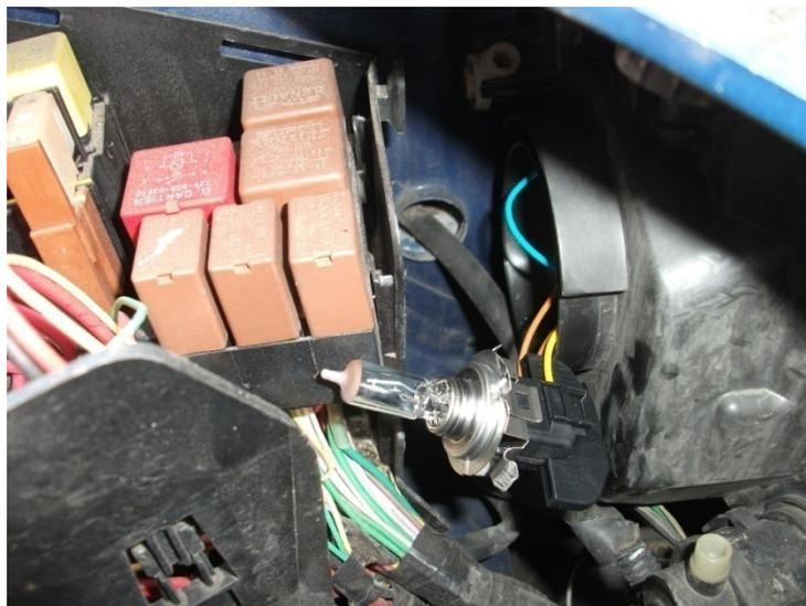
Abb. 29: Entnommener Sockel mit Halogenlampe
