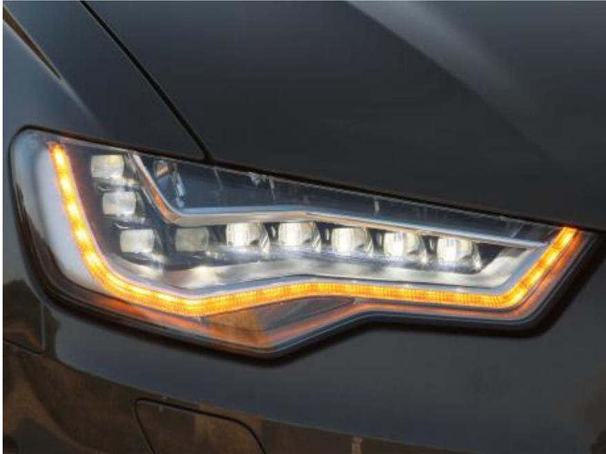
Abb. 25: LED-Scheinwerfer mit einer defekten LED
