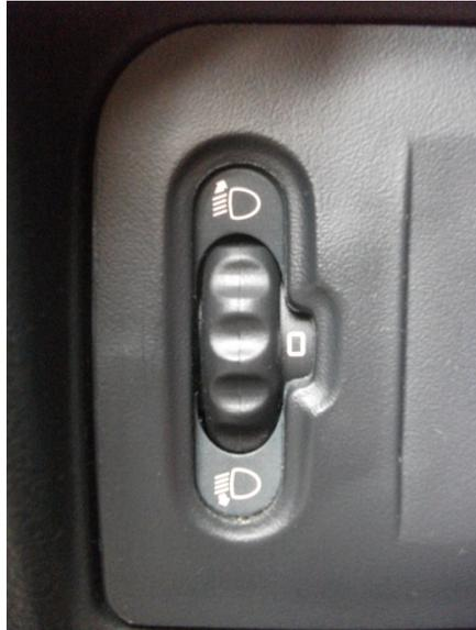
Abb. 18: Schalter einer Leuchtweitenregelung
