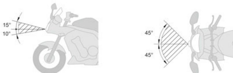
Abb. 3: geometrische Sichtbarkeit des Abblendlichtes eines Motorrades
