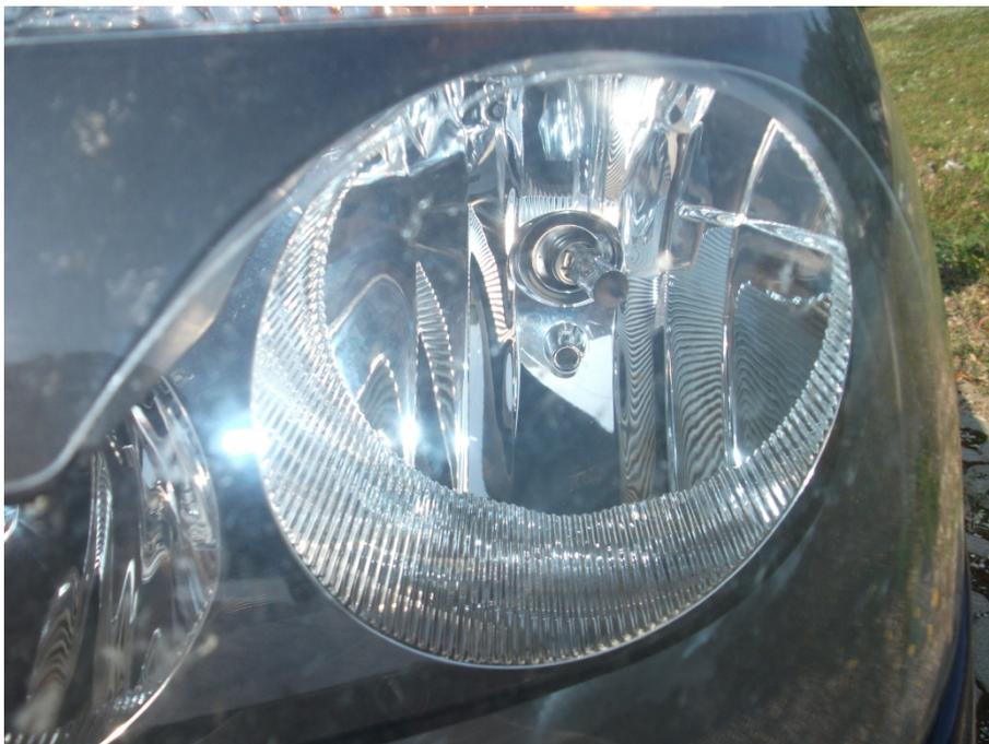
Abb. 21: Scheinwerfer mit falsch eingesetzter Lampe
