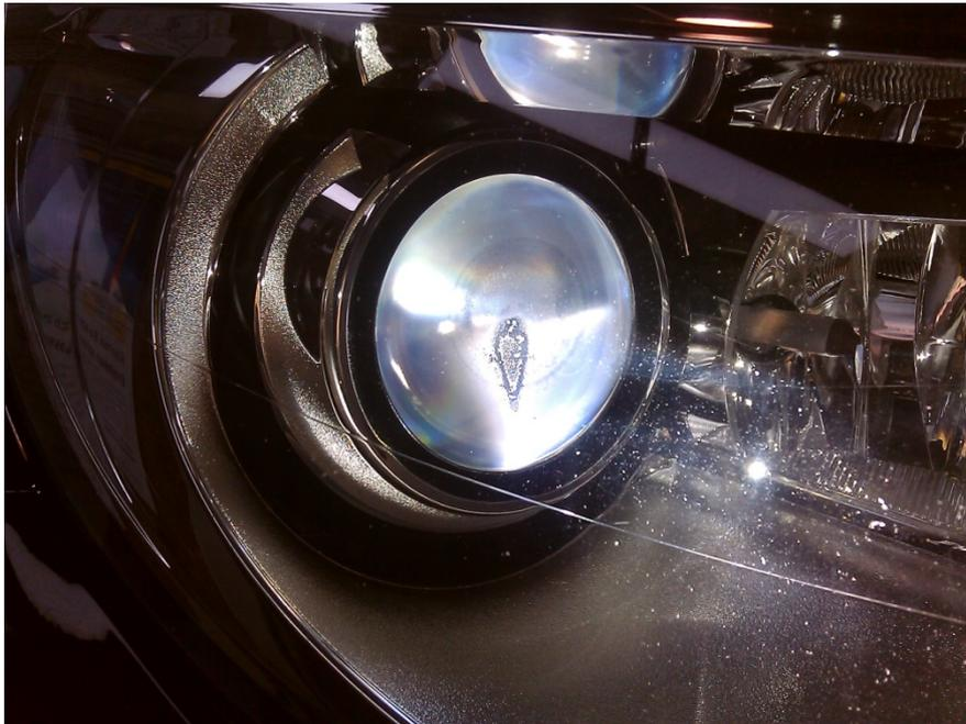
Abb. 24: Feuchtigkeitsansammlung in der Xenonlinse eines VW Passat
