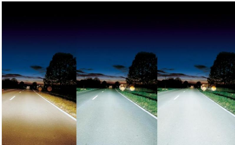
Abb. 14: Vergleich von Halogen-, Xenon- und LED-Scheinwerfer
