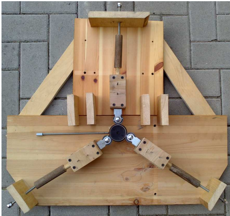
Abb. 30: Holzmodell der Anpressrollen (Quelle: Foto, Eigenerstellung)
