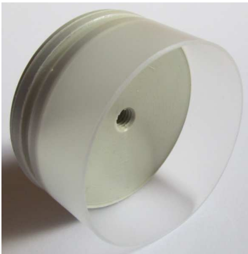
Abb. 28: Schweißergebnis mit PP-Kappe (Quelle: Foto, Eigenerstellung)
