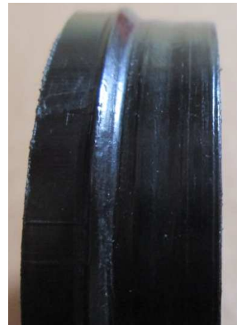
Abb. 02: Schwarze PE-Kappe nach Schweißversuch (Quelle: Foto, Eigenerstellung)
