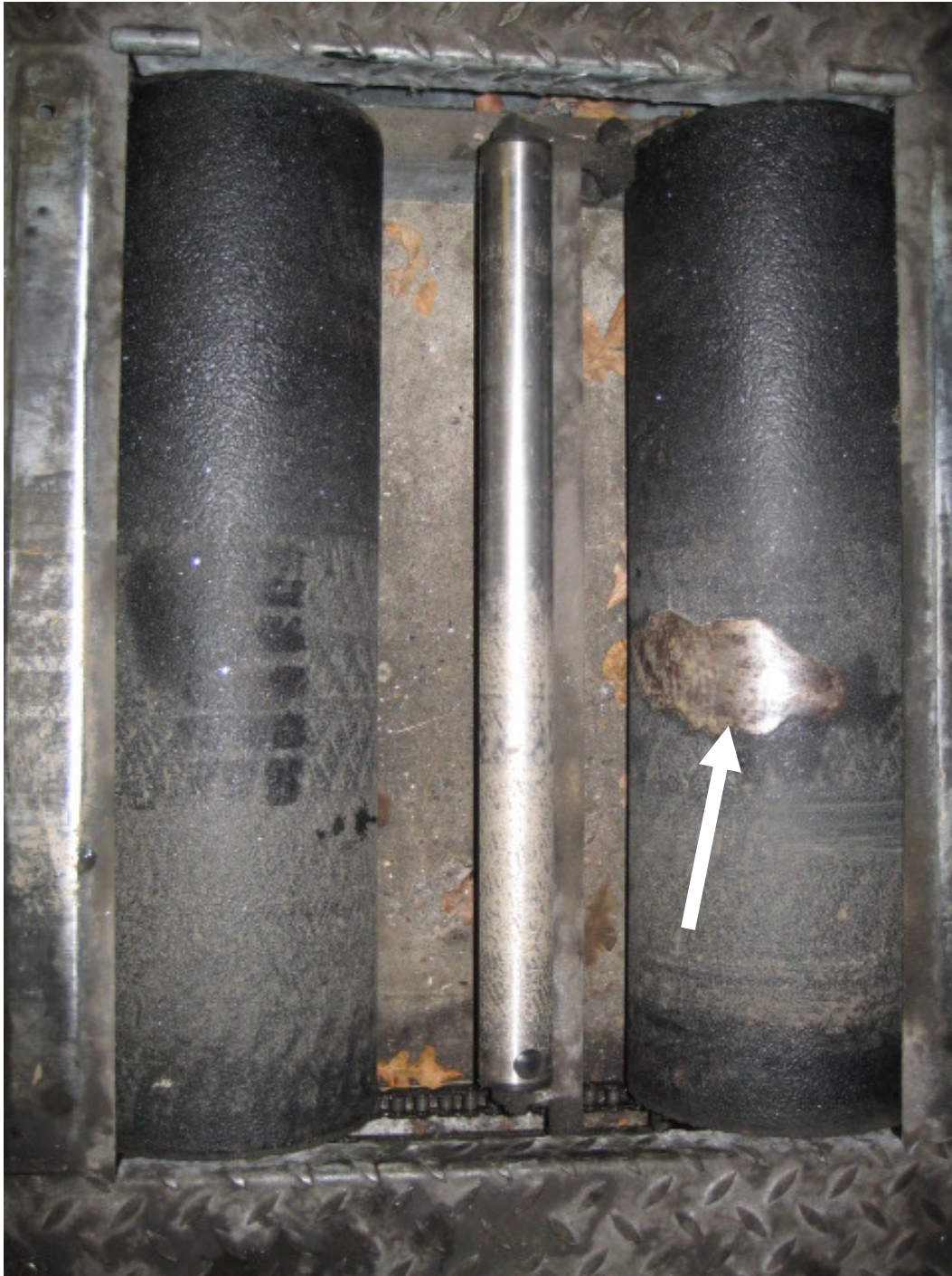
Anl.VI: „Beschädigungen“ Rollenbremsprüfstand
