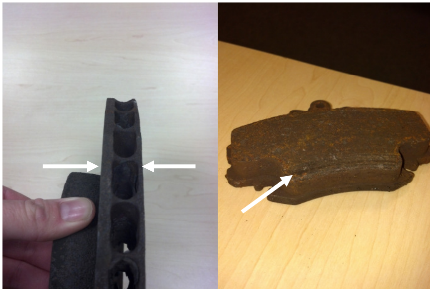
Abb.30: Ungleichmäßig verschlissene Bremsscheibe/Bremsbelag
