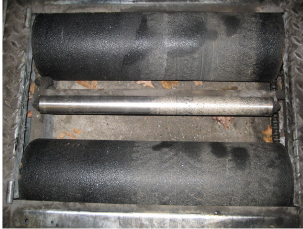
Abb.19: Antriebsrollen und Tastrolle des Rollenbremsprüfstandes
