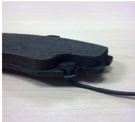
Abb.31: Bremsbelag mit Verschleißanzeige
