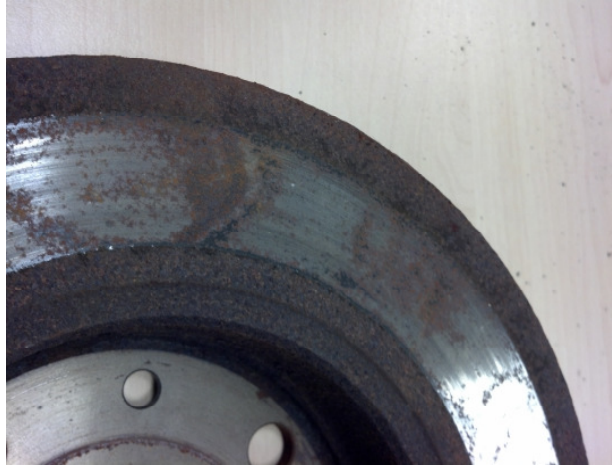
Abb.32: „beanstandetes Tragbild“ einer Bremsscheibe
