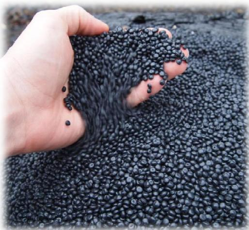
Abbildung 1.1: Schwarz eingefärbtes Kunststoffgranulat (Quelle: eigene Aufnahme)
