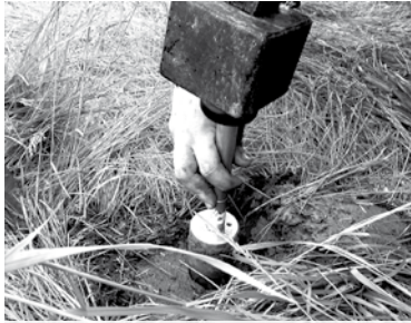
Abb. 1 : Entnahme einer Bodenprobe mittels Stechzylinder zur Bestimmung der Trockenrohdichte und Aufsicht
