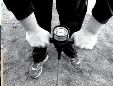
Abb. 4 : Bestimmung des Eindringwiderstandes in den Boden per Penetrometer
