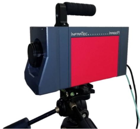
Abbildung 19: Infrarotkamera „ImageIR® 8800“ der Firma InfraTec GmbH
