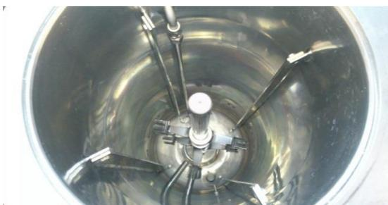
ABBILDUNG 10: RÜHRWERK IM 70L-FERMENTER
