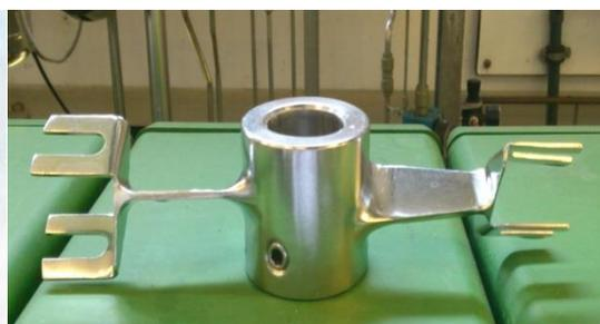
ABBILDUNG 11: RÜHRERELEMENT DES INTERMIG-RÜHRWERK
