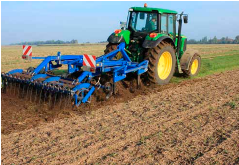
Bodenvorbereitung durch Grubbern [16]
