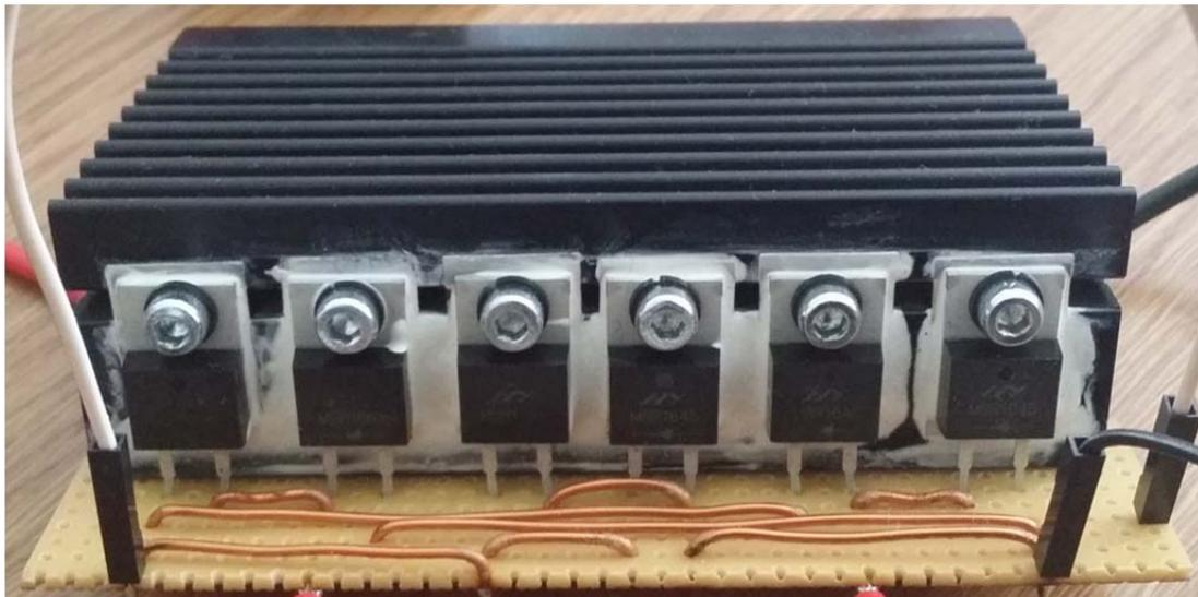
**Bild 3.22: montierte Schottky-Dioden**
