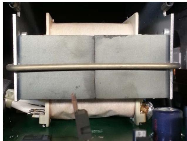
**Bild 2.26: Trafokern aus Dynamoblech (links) und Ferrit (rechts)**
