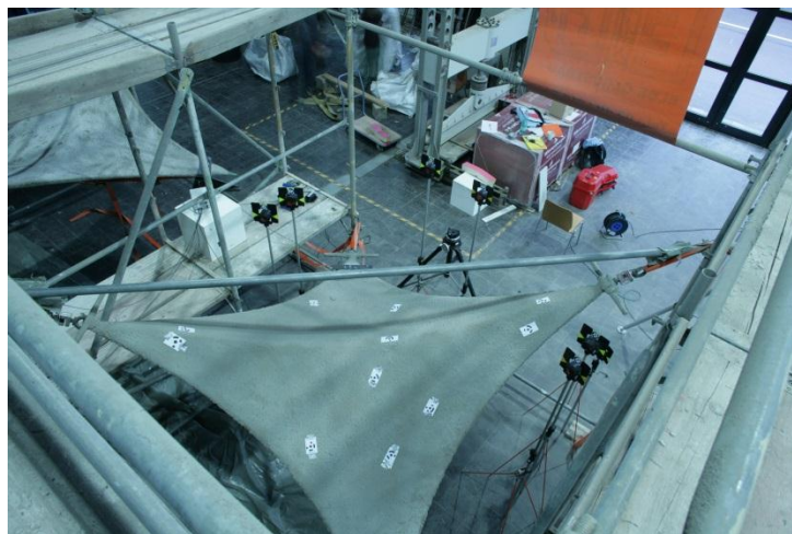
Abb. 5.1.1: Schalenelement in Ausgangslage umschlossen mit Passpunkten auf Zieltafeln für die spätere Verknüpfung der aufgenommenen Bilder.
