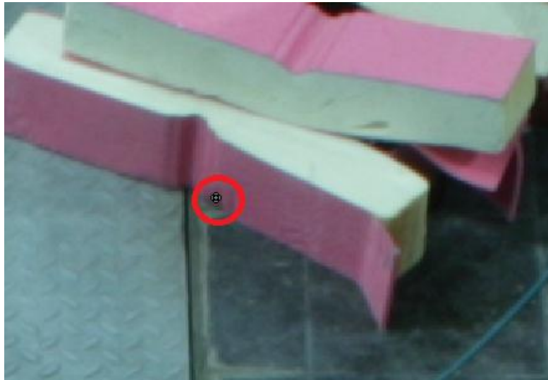
Abb. 6.3.2: Fehlerhafte Erkennung einer angeblichen Zielmarke an einem Schaumstoffteil.
