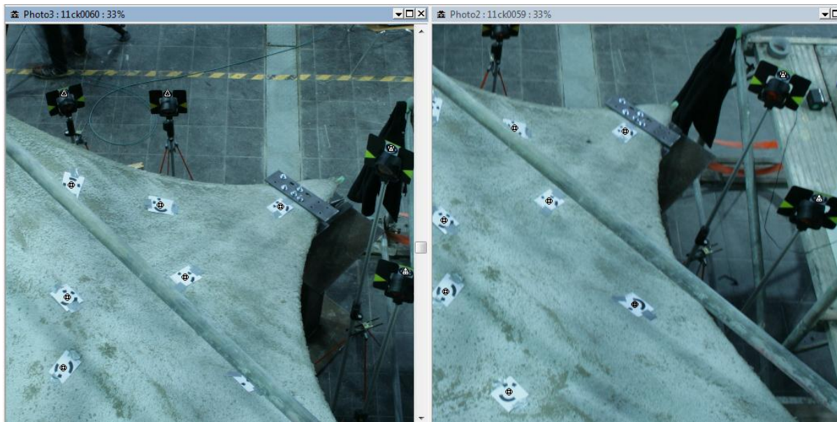
Abb. 6.3.3: Verknüpfung der Zielmarken untereinander und Georeferenzierung der Marken auf den Zieltafeln (Dreieckssymbol).
