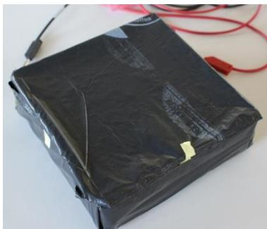
Abb. 23: abgedunkelte Box; Kiste und Deckel jeweils mit schwarzer Folie ummantelt
