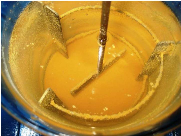
Abb. 0-31 Rührapparat, Rotor und Stator
