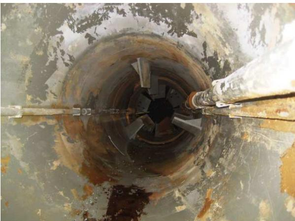
Abb. 0-13 Mischzone nach Reinigung
