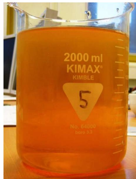
Abb. 0-35 Versuchsreihe 1 Ladungsumkehr, es entstehen keine Flocken
