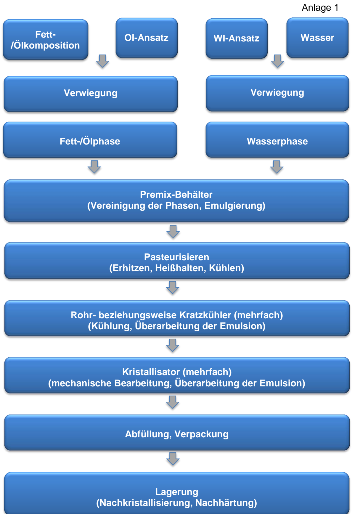
Abbildung 1: Prinzipielle Verfahrensschritte beim Premix-Verfahren
