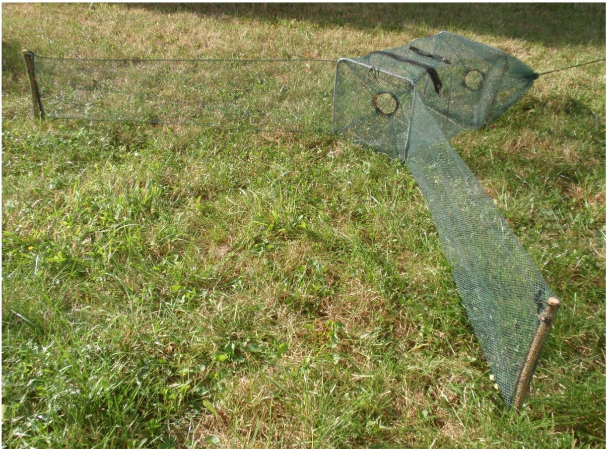
Abbildung 6: Kleinfischreuse Typ B mit Flügeln
