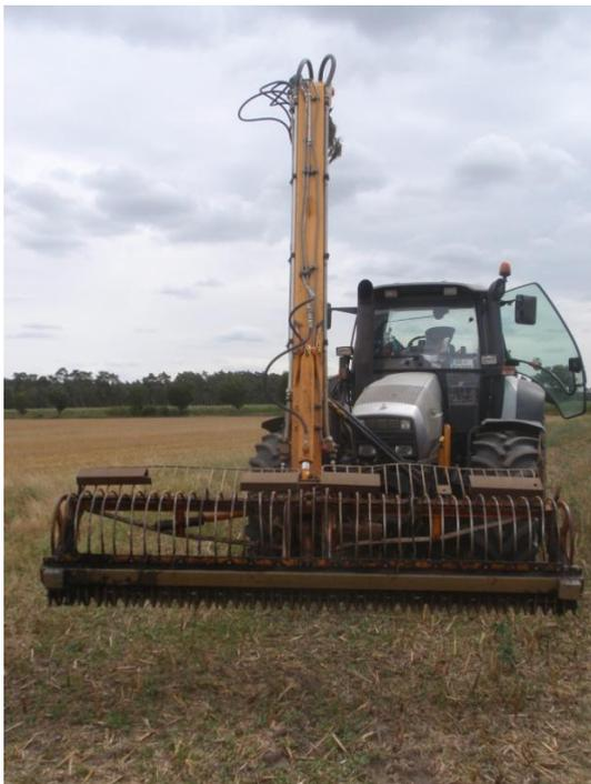
Abbildung 11: Traktor mit hydraulischem Mähkorb
