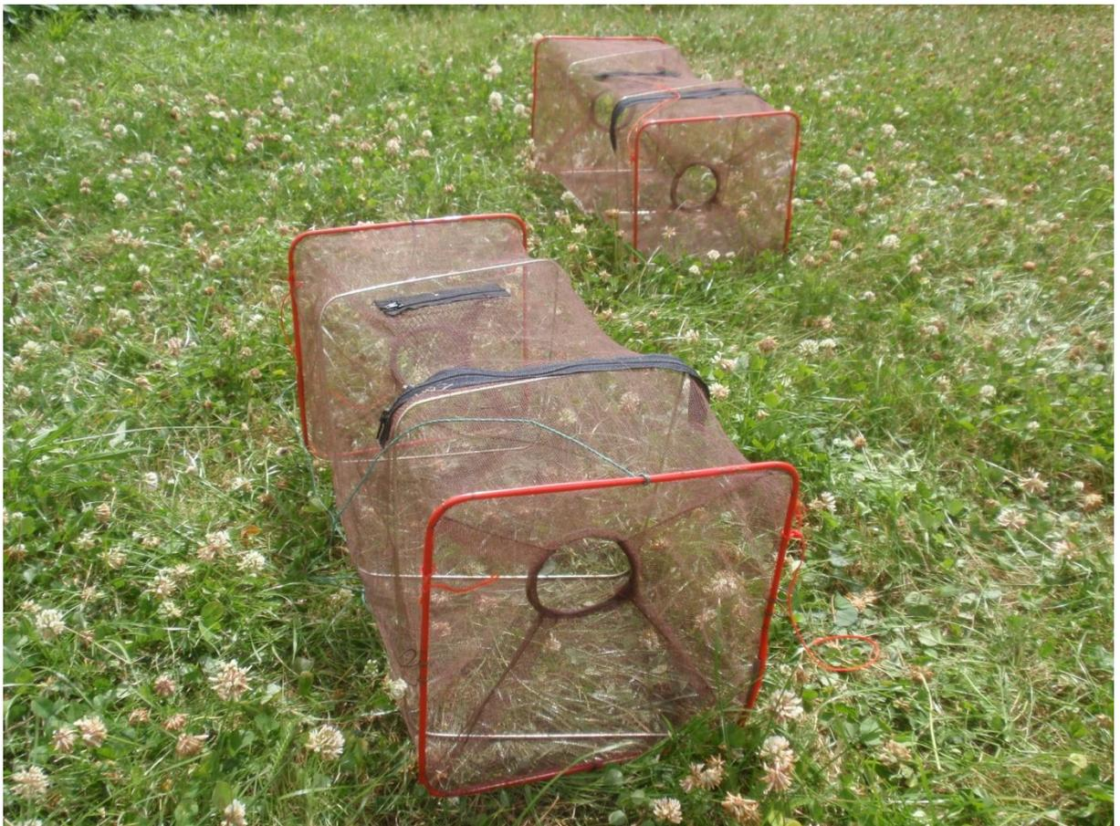
Abbildung 7: Zwei Kleinfischreusen, zusammen verwendet als Reusentyp C
