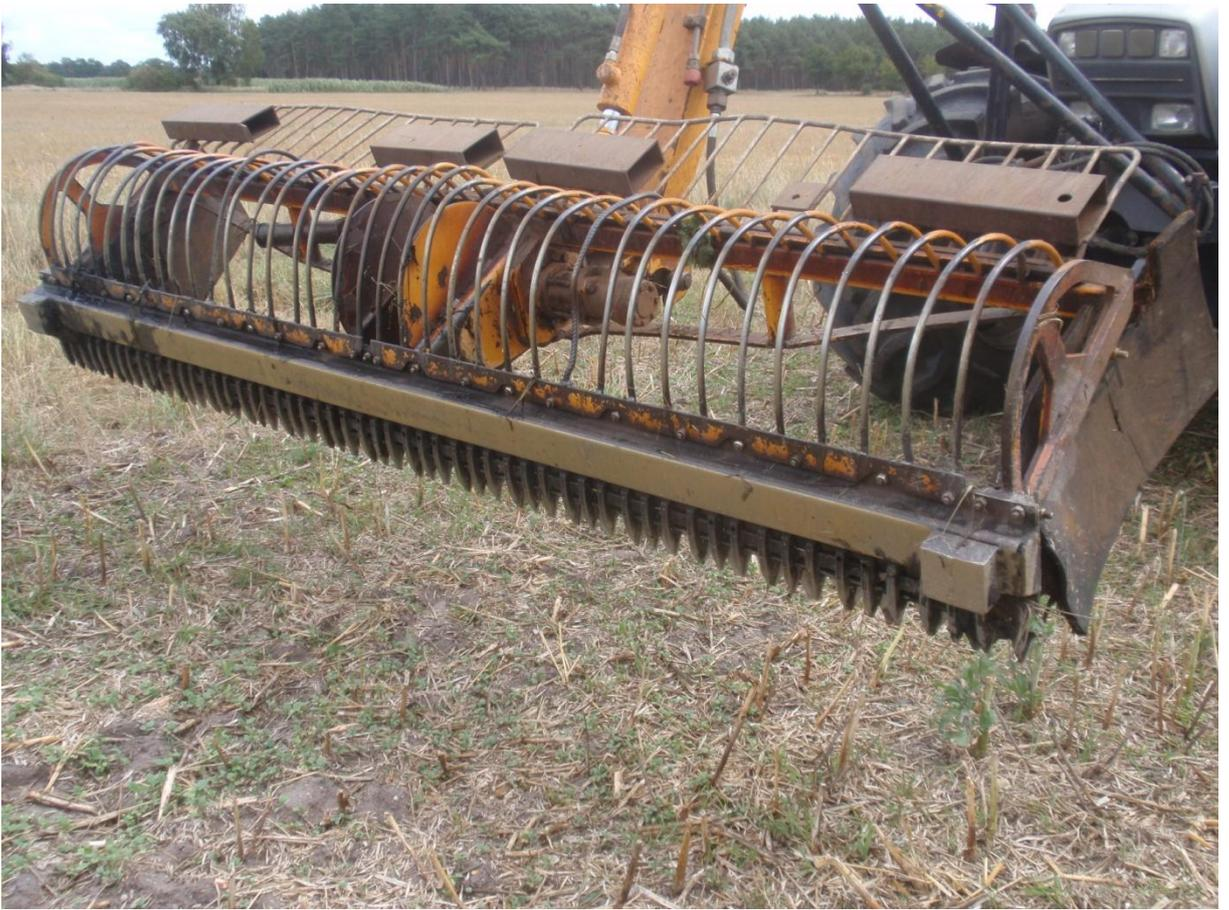
Abbildung 13: Detailansicht des Mähkorbs mit den beiden Abstandshaltern
