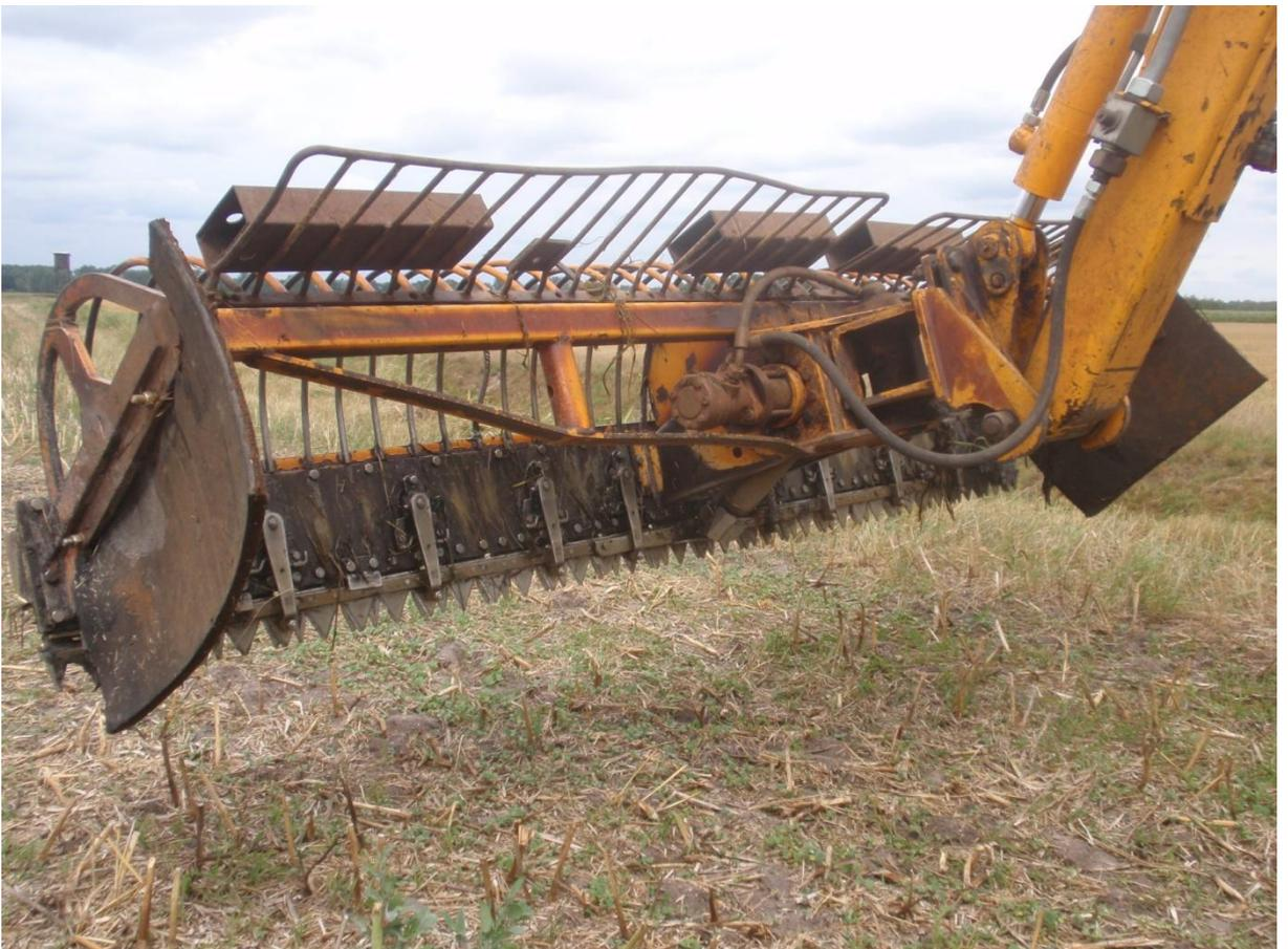
Abbildung 14: Innenansicht des Mähkorbs mit dem Messerbalken
