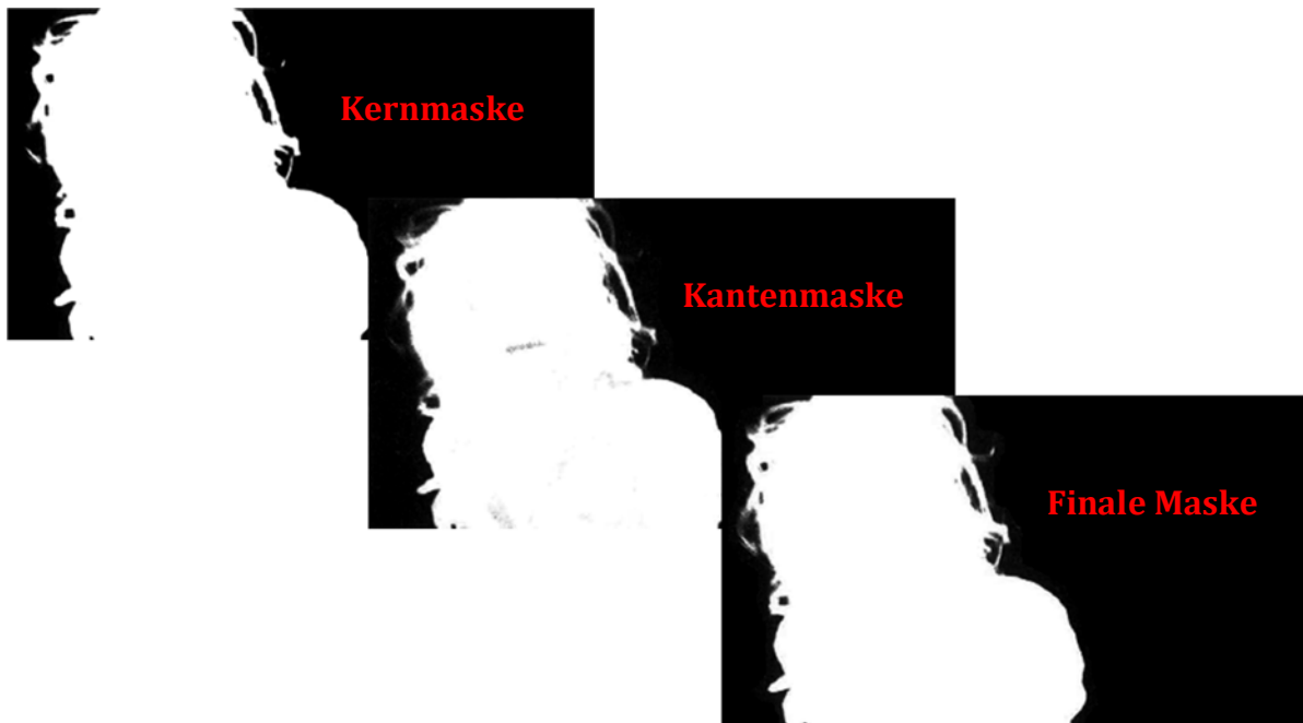
Abbildung 2.96 Beispiel für Kernmaske, Kantenmaske und Kombination beider Masken (finale Maske)[DUM10]
