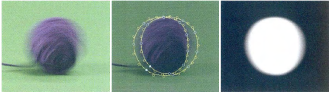
Abbildung 2.83 Beispiel Vordergrund mit Bewegungsunschärfe, Splines und Maske [WRI11]
