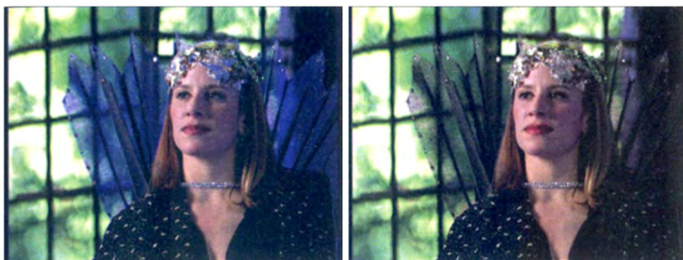
Abbildung 2.93 Beispiel Vordergrund mit Spill vor neuem Hintergrund und Vordergrund mit Despill vor neuem Hintergrund [DUM10]
