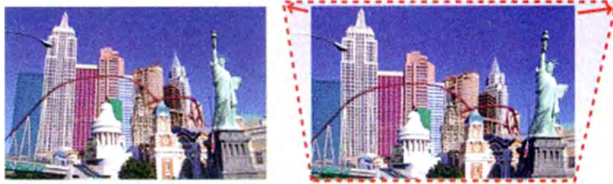
Abbildung 2.101 Beispiel Bild mit stürzenden Linien und korrigiertes Bild [DUM10]
