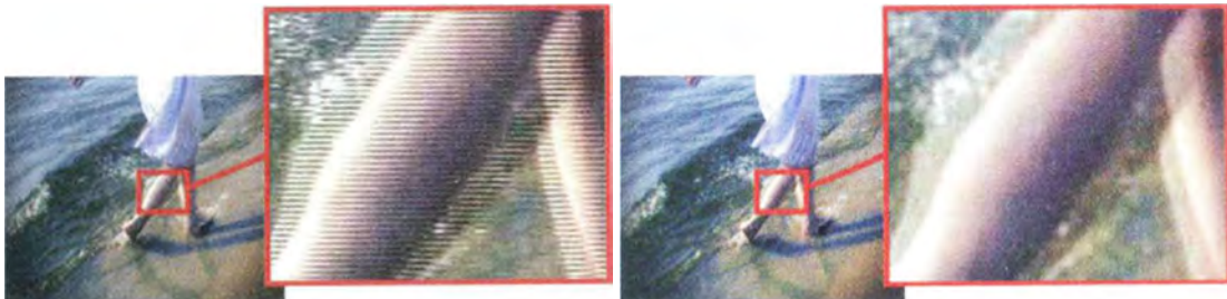
Abbildung 2.17 Beispiel Interlaced Bild (links) und Beispiel Field Merge (rechts) [DUM10]
