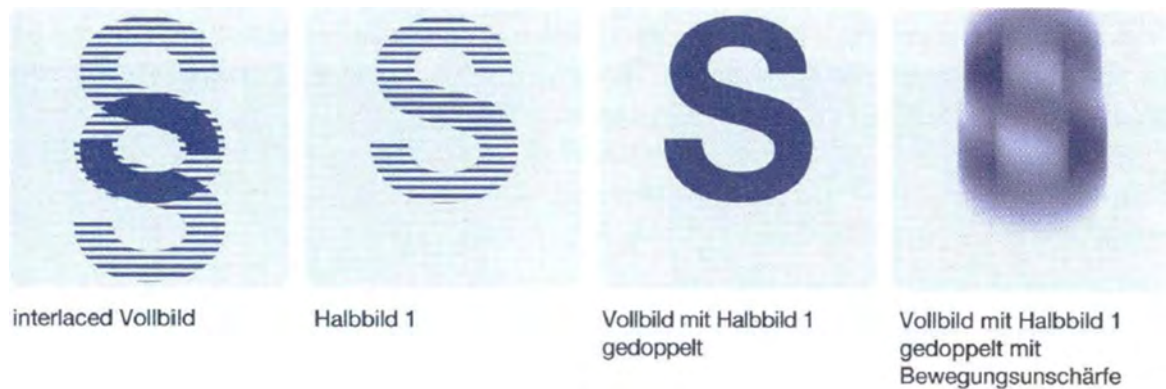
Abbildung 2.18 Progressivbildberechnung durch Doppelung eines Halbbildes [DUM10]
