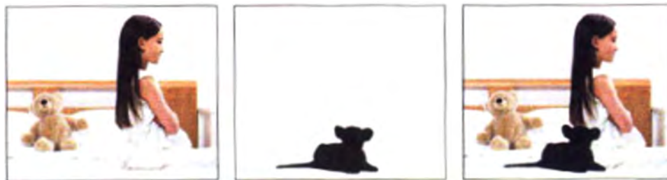
Abbildung 2.77 Hintergrund + invertierte Maske Vordergrund = vormultiplizierter Hintergrund [DUM10]
