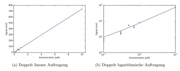
Abbildung 38: Datenpunkte der Kalibrierungsmessungen 1 und 2 und daraus berechnete Kalibrierkurve
