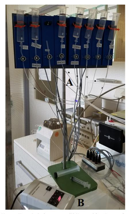
Abbildung 16: Verwendet Perfusionssystem. (A) Vorratsgefäße in Form von Spritzen, (B) Steuerungseinheit
