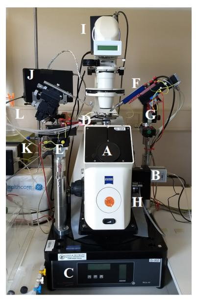
Abbildung 13: Manueller Patch Clamp Aufbau. (A) Inverses Mikroskop, (B) Kamera, (C) Schwingungsgedämpfter Tisch, (D) Messkammer, (E) Manueller 2-Achsen Mikromanipulator für die Messkammer, (F) Patch Clamp Vorverstärker, (G) 3-Achsen Mikromanipulator für die Patchpipette, (H) 1-Achsen Mikromanipulator für das Mikroskop, (I) Beleuchtungseinheit, (J) Durchflusszelle in schwarzer Box, (K) Peristaltikpumpe des Ablaufs, (L) Ablaufgefäß
