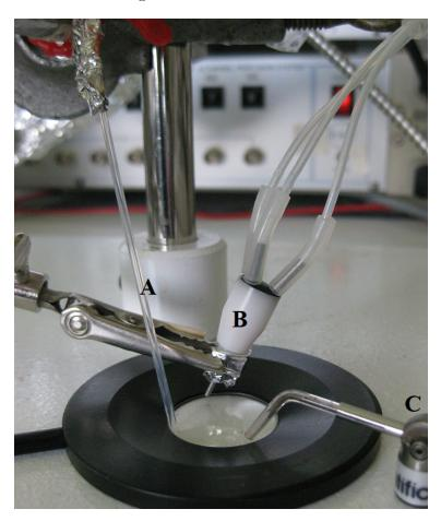
Abbildung 8: Messkammer für erste Tests. (A) Eingang zur Durchflusszelle. (B) Zulaufvorrichtung des Perfusionssystems. (C) Absaugvorrichtung
