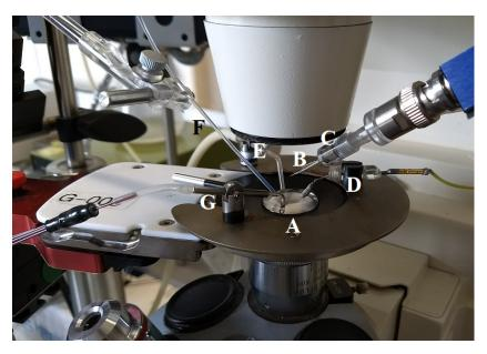
Abbildung 14: Messkammer des manuellen Patch Clamp Aufbaus.
