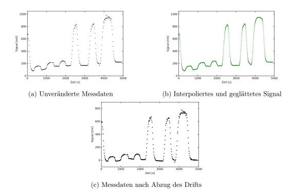
Abbildung 37: Nachbearbeitung des Signals schematisch dargestellt für Kalibriermessung (1)
