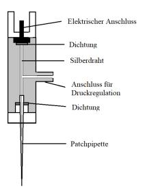
Abbildung 15: Schematischer Aufbau der Halterung für die Patchpipette (eigene Darstellung, nach [16])
