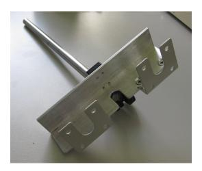
Abbildung 11: Halterung für die Durchflusszelle
