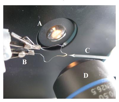
Abbildung 12: Microforge zum Feuerpolieren der Patchpipetten. (A) Lichtquelle, (B) heißer Draht, (C) Patchpipette, (D) Objektiv
