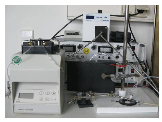
Abbildung 10: Letzter Versuchsaufbau vor der Integration des UV-vis-Detektors in den Patch Clamp Stand
