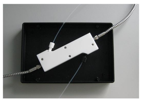
Abbildung 9: Einbau der Durchflusszelle in eine schwarze Kunststoffbox zum Schutz vor Lichteinflüssen
