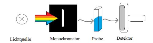
Abbildung 4: Schematische Darstellung eines Einstrahl-UV-vis-Spektrometers (eigene Darstellung, nach [17])
