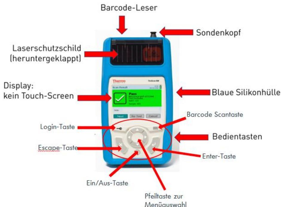
Abb. 23: Aufbau des TruScan RM-Spektrometers [9]
