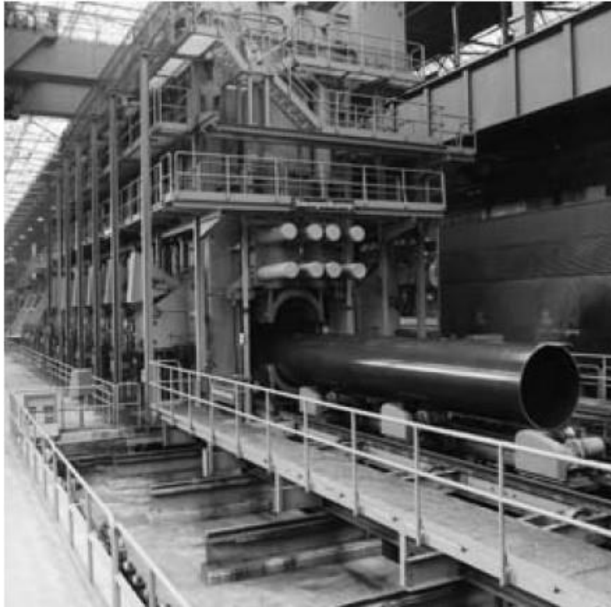
Abbildung 3-11 [2] : Fertigung zum Schlitzrohr in der O-Pressen
