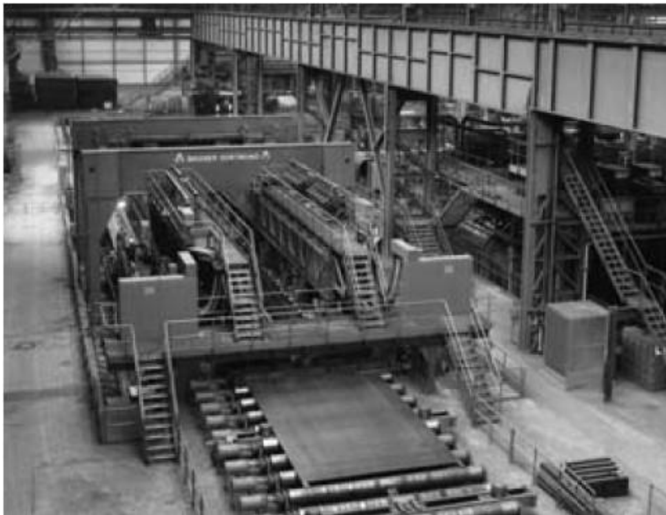
Abbildung 3-8 [2] : Anhobeln beider Längskanten einschließlich der An- und Auslaufstücke
