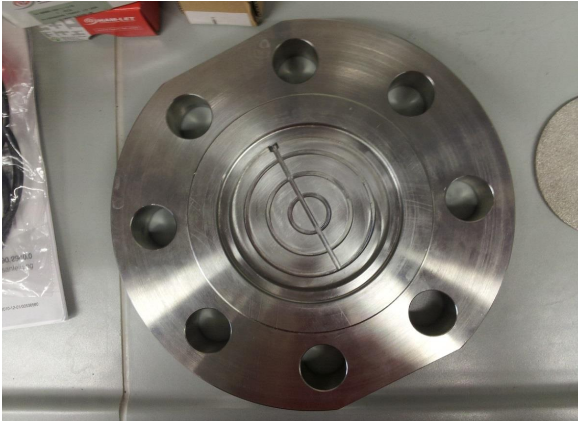
(Abbildung 8: unterer Blindflansch mit Drainagerinnen)
