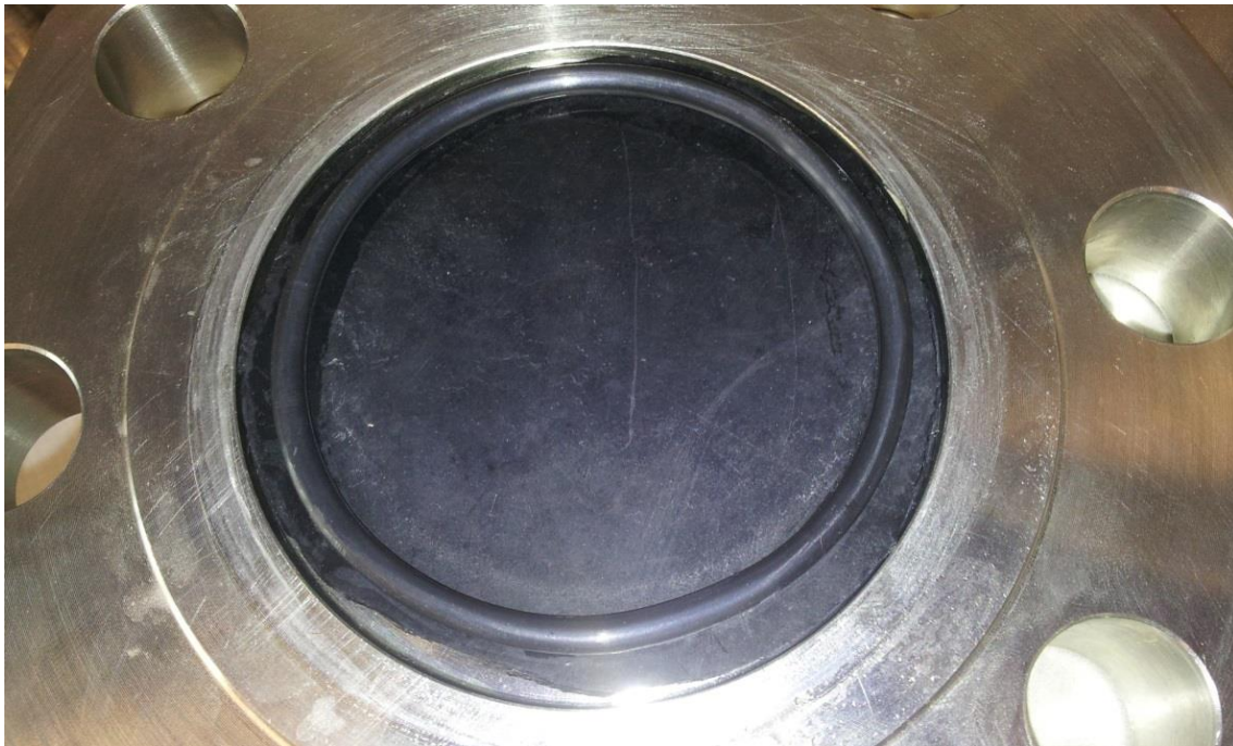
(Abbildung 17: unterer Flansch mit Gummischicht und Dichtungsring)
