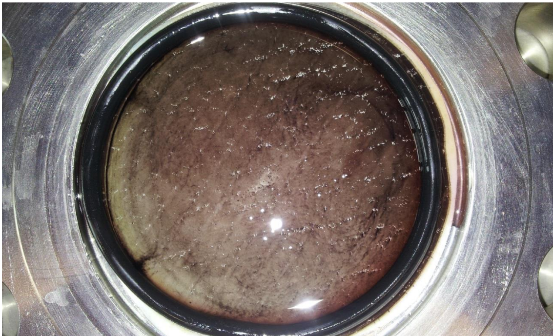
(Abbildung 25: Membran nach Benutzung)
