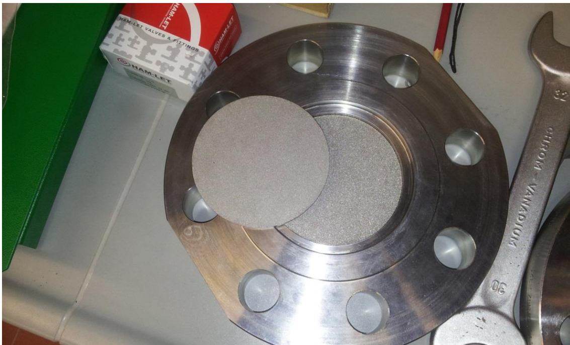
(Abbildung 9: unterer Blindflansch mit beiden Sinterplatten)
