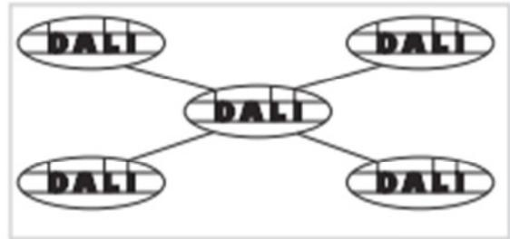
Abbildung 13: Sternstruktur<sup>16</sup>
