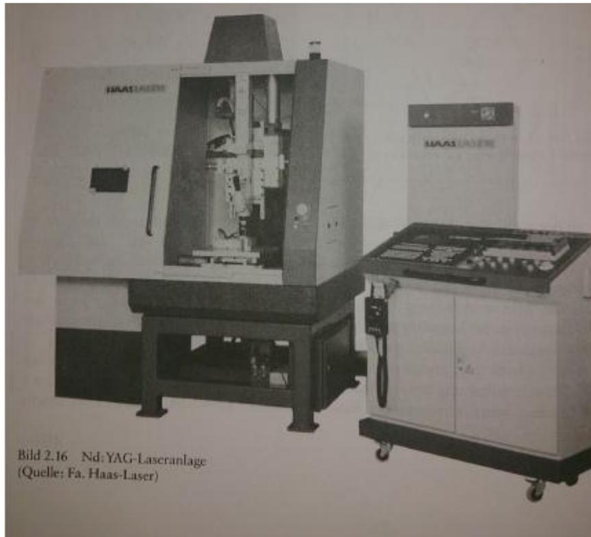
**Abbildung 10 Nd:YAG-Laseranlage**
