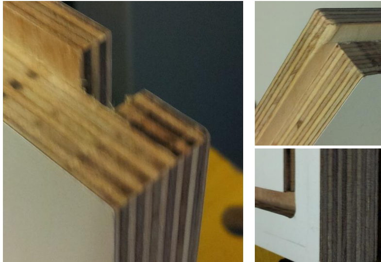
Abbildung 5.1: Schnittqualität der Oberfräse
