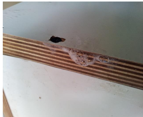
Abbildung 5.3: Versuchsaufbau und Leckagestelle
