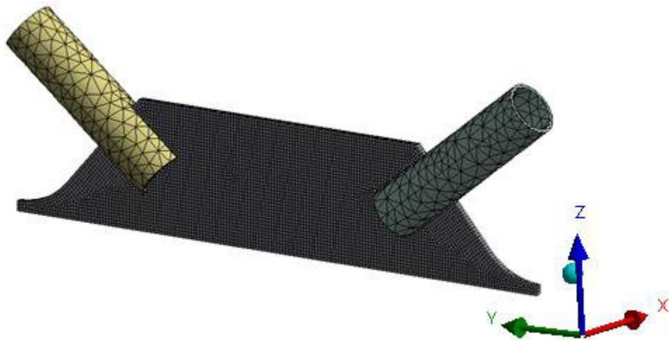
Abb. 4.18: Vernetztes Volumenmodell des Knotenblechanschlusses
