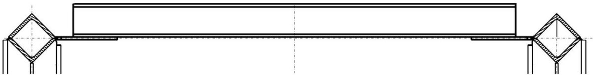
Abb. 3.8: Verstärkung am Obergurt - Breitflansch
