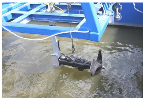
Abb. 2: Axialturbine TR 75-2.19-4/16 mit 3 Schaufeln an der Haltevorrichtung der Versuchsplattform Vector
