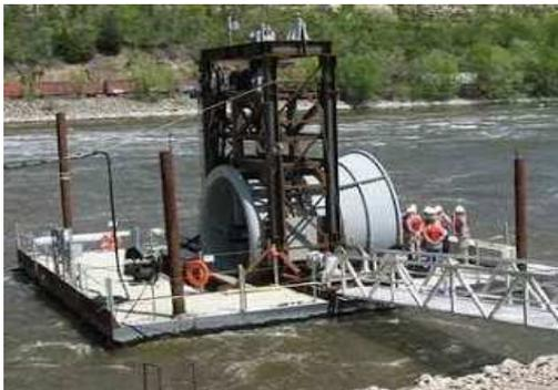
Abb. 25 hydrokinetische Turbine mit  $d = 2$  m Durchmesser in den USA
