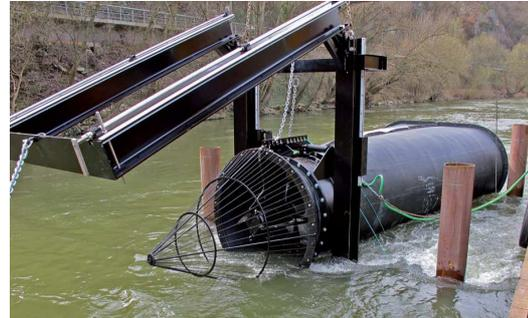
Abb. 24 hydrokinetische Turbine der Firma KSB Frankenthal
