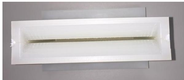
**Abb. 28:** Ätzkammer, die zur Modifizierung der Oberflächenextraktion der Waferoberflächen verwendet wurde (links: Vorderansicht; rechts: Draufsicht)
