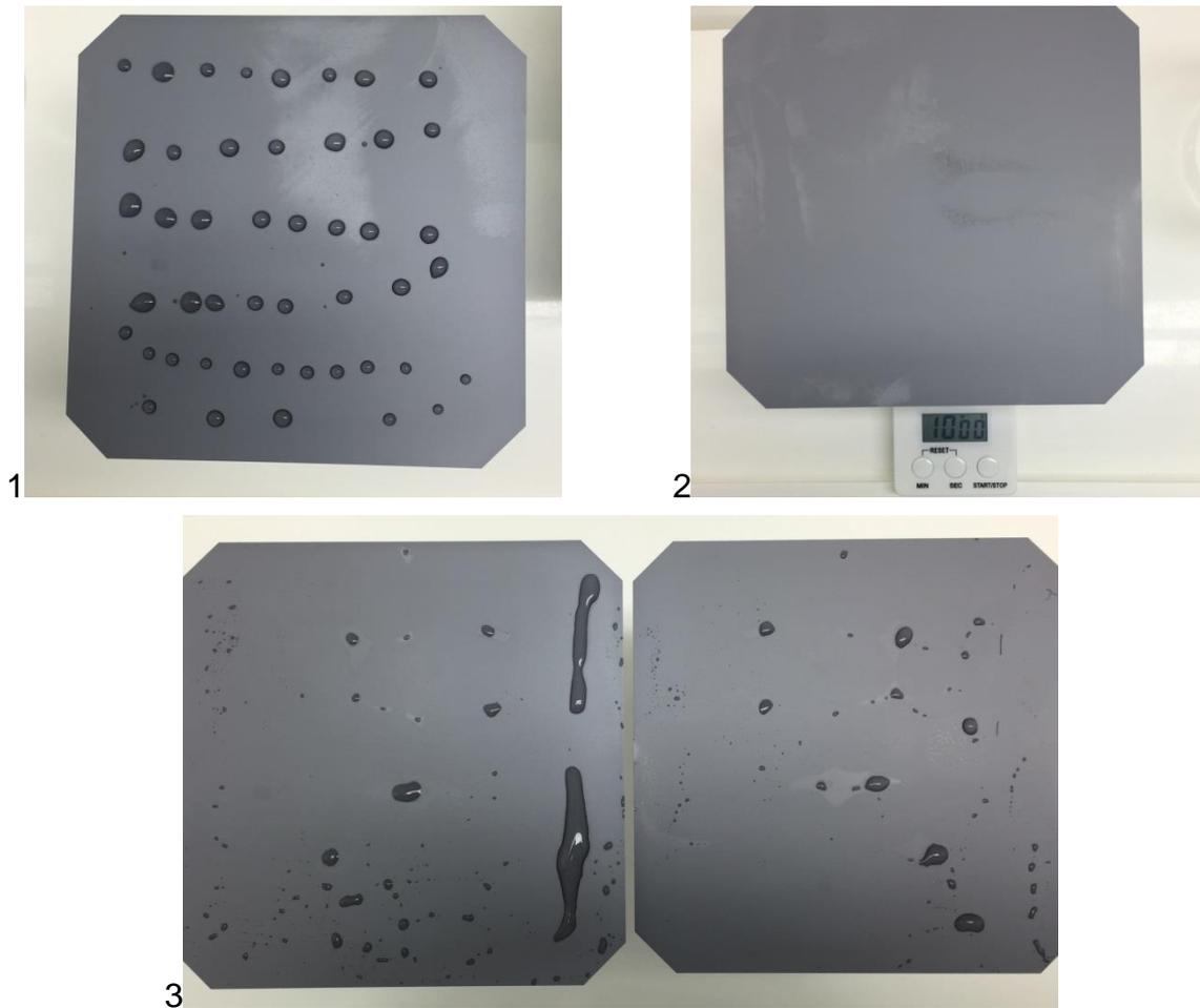
**Abb. 09:** Extraktion der Waferoberfläche mittels Sandwich-Methode
