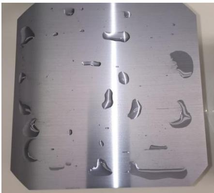
**Abb. 34:** hydrophobes Verhalten nach zehnmütiger Einwirkung der HF/HNO<sub>3</sub>-Lösung auf as-cut Waferoberflächen
