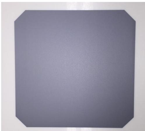
**Abb. 08:** Form der verwendeten monokristallinen Siliziumwafer
