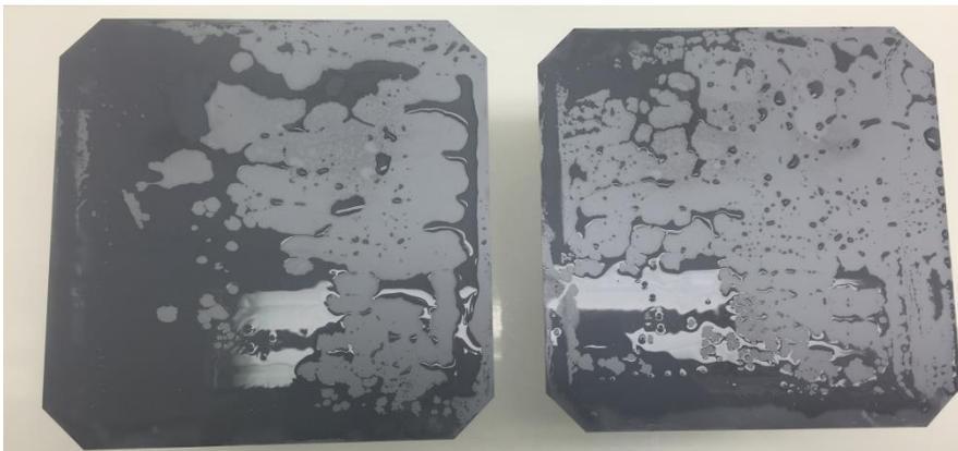
**Abb. 33:** mit Phasenfluiden vorbehandelte Waferoberflächen nach zehnmütiger Einwirkung der HF/HNO<sub>3</sub>-Ätzlösung
