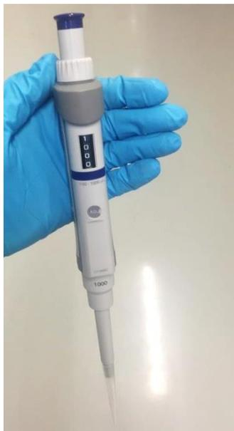
**Abb. 10:** verwendete Kolbenhubpipette für die Extraktion der Wafer
