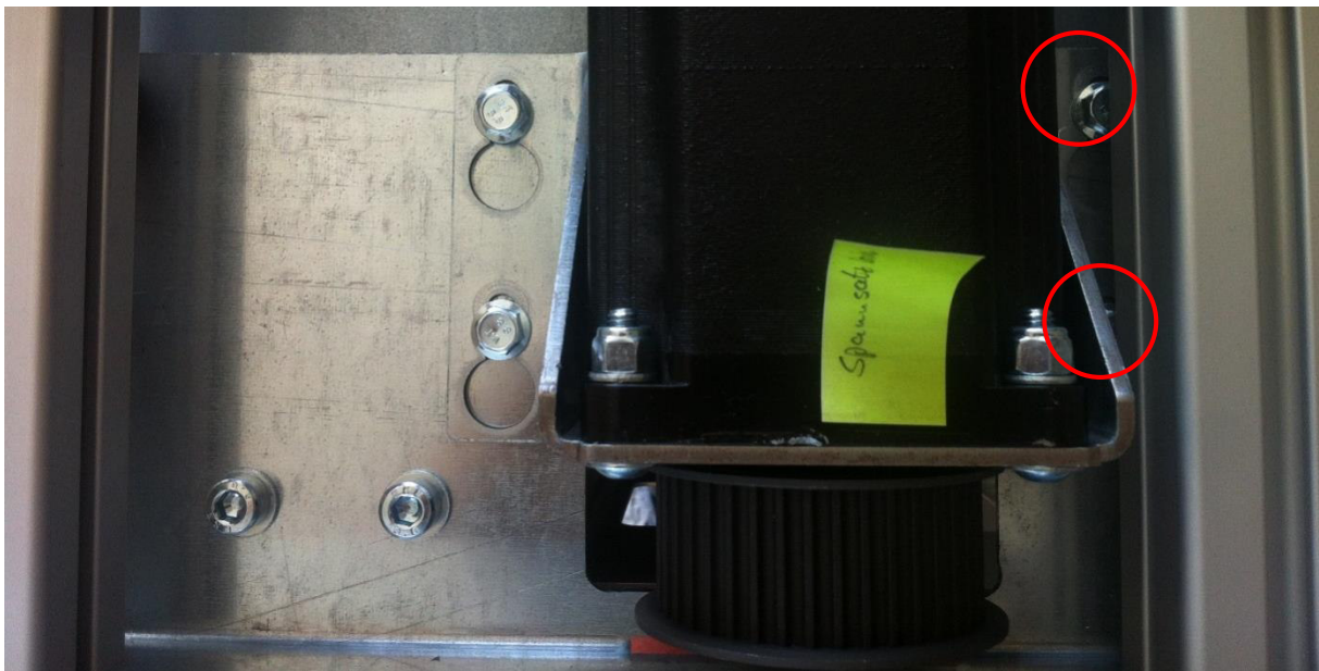
Abbildung 37: Problem Schrauben Motorhalter
