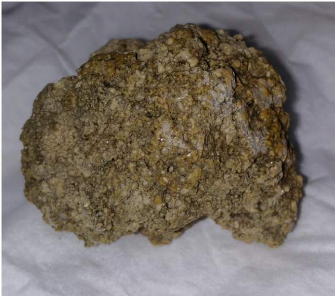
Abb. 17: Aggregat, das sich am Ende der Versuche im Reaktor befand (4 cm bis 6 cm groß)
