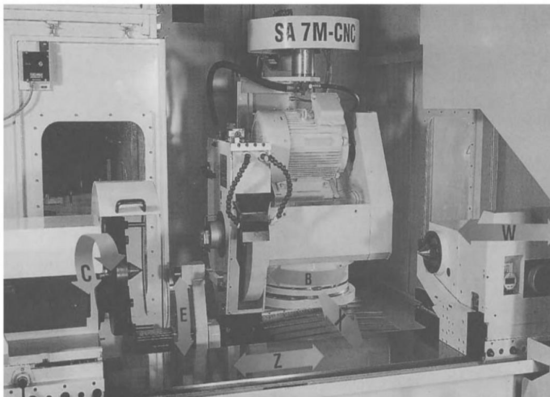
Abb.9: Beispiel einer Außenrundschleifmaschine; Arbeitsraum mit Bezeichnung der NC-Achsen (Werkbild: Schleifmaschinenwerk Chemnitz) [4]
