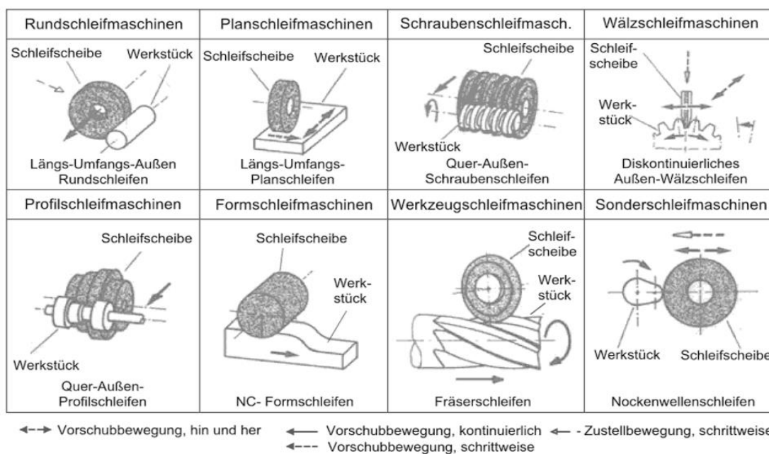
Abb.7: Wirkprinzipien von Schleifmaschinen-Bauarten [3]
