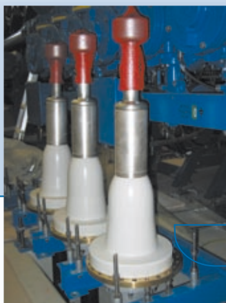
KSEV 145: Schalterendverschluss in trockener Ausführung
