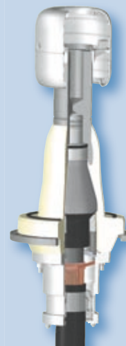
KSEV 145: Schalterendverschluss in trockener Ausführung
