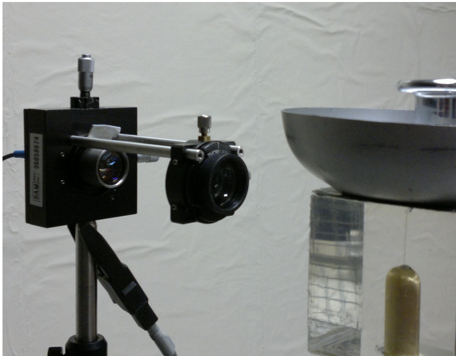
Abbildung 28 Ausrichtung des Linsensystems auf einen Prüfkörper [8]
