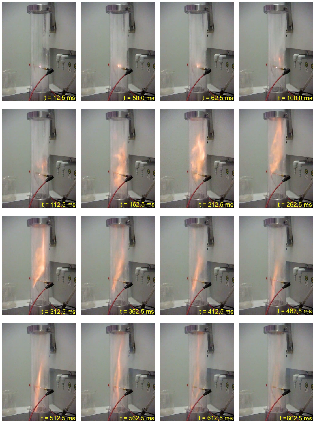
Abbildung A.3: Nicht das ganze Hartmann-Rohr ist von Flammen ausgefüllt.
