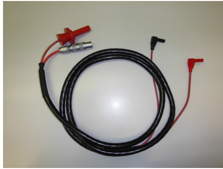
Abbildung 4.4: Energieübertragungskabel vom MIE III zum Hartmann-Rohr.
