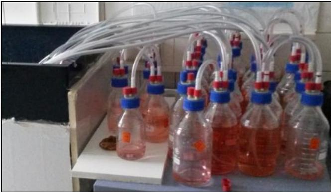
**Bild 22: Laborflaschen zur Gasvolumenmessung der einzelnen Ansätze**
