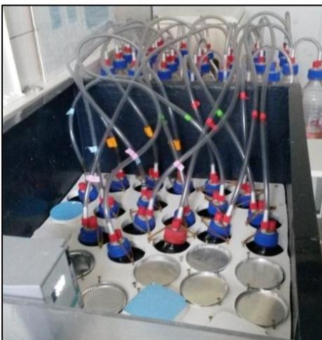
**Bild 21: Wasserbad des Fachbereichlabors mit Faulansätzen**
