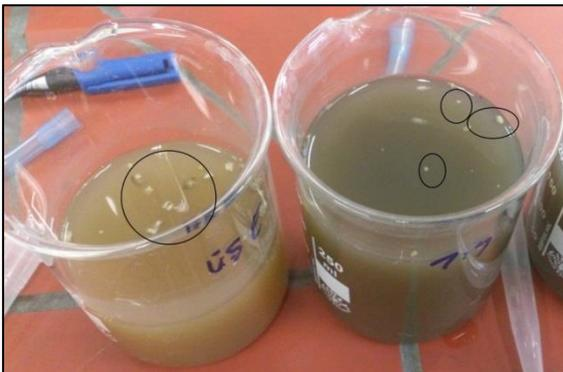
**Bild 17: Flocken in den Ansätzen ÜSS + E (links) und 1:1 (rechts)**
