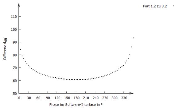
Abbildung 14: Dämpfung in Abhängigkeit zur Phase
