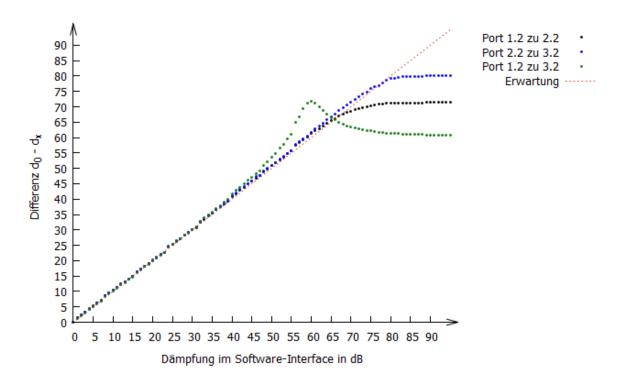
Abbildung 13: Dämpfungsverlauf Mehrantennenports bei 2,45 GHz
