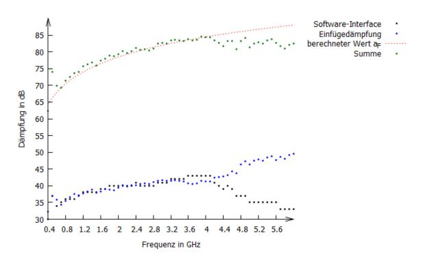
Abbildung 12:Frequenzabhängige Freiraumdämpfung
