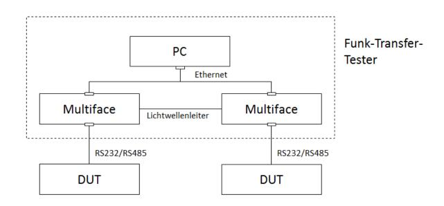
Abbildung 7: Funk-Transfer-Tester Aufbau
