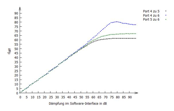
Abbildung 17: Dämpfungsverlauf Einantennenports bei 2,45 GHz
