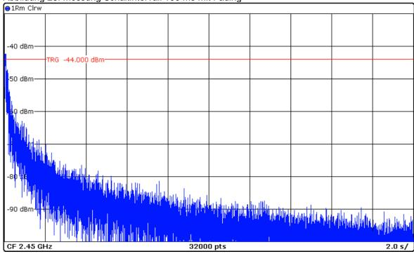
Abbildung 29: Messung Schaltintervall 100 ms mit korrigierten Fading
