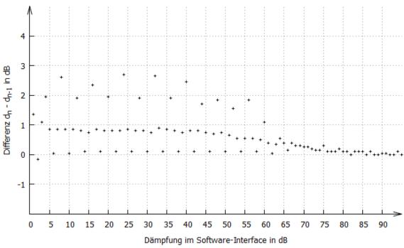
Abbildung 20: Schaltdifferenz zum vorhergehenden Wert Port 1.2 zu Port 4
