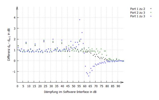
Abbildung 16: Schaltdifferenz bei Mehrantennenports bei 2,45 GHz
