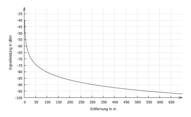
Abbildung 24: Freiraumdämpfung bei 2,45 GHz
