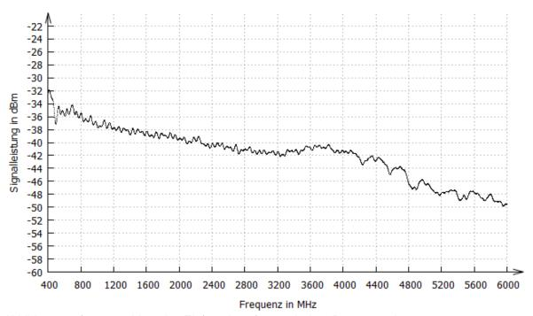
Abbildung 10: frequenzabhängige Einfügedämpfung zwischen Port 1.2 und 2.2
