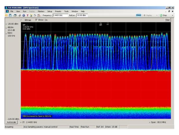
Abbildung 31: Genutzte Frequenzen im 2,4 GHz ISM Band
