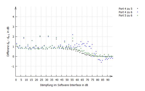
Abbildung 18: Schaltdifferenz bei Einantennenports bei 2,45 GHz
