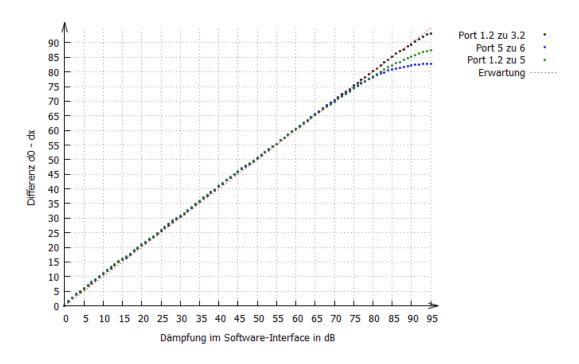
Abbildung 21: Dämpfungsverlauf Softwareinterface 500 MHz
