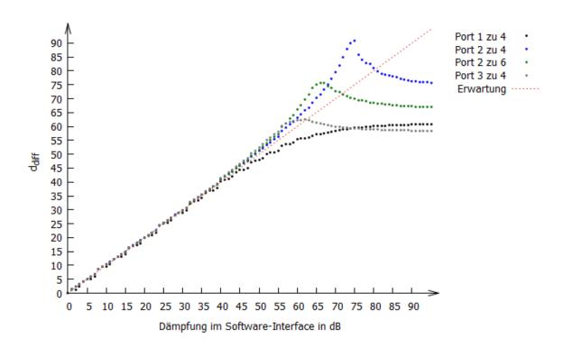
Abbildung 19: Dämpfungsverlauf Einantennenports zu Mehrantennenports
