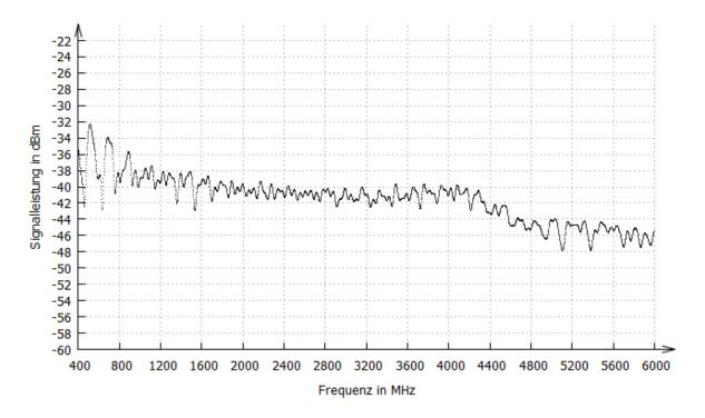
Abbildung 11: frequenzabhängige Einfügedämpfung zwischen Port 4 und 5
