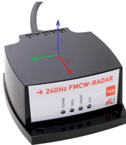
Abbildung 9: Definition der Schwingrichtungen anhand des Radarmoduls
