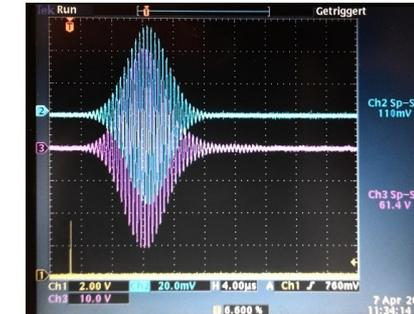
Abbildung 68: Anregungssignale gemessen am Eingang (türkis) und am Ausgang (rosa) des Verstärkers. Die Frequenz des gaußgefensterten Sinusbursts betrug 2,0 MHz.
