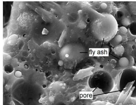
f) F06 Al 0,1 showing pores and fly ash residues
