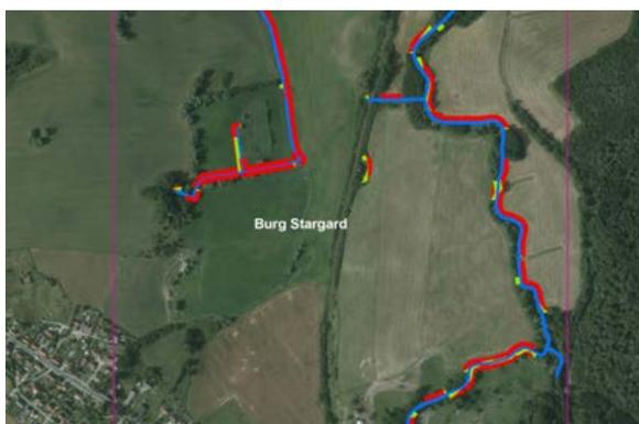
**Abb. 60** Beispiel für die Gewässerstrecken (rot), für die aufgrund der derzeitigen natürlichen Ausstattung und Landnutzung potentiell höhere Eintragsrisiken bestehen (eigene Darstellung)
