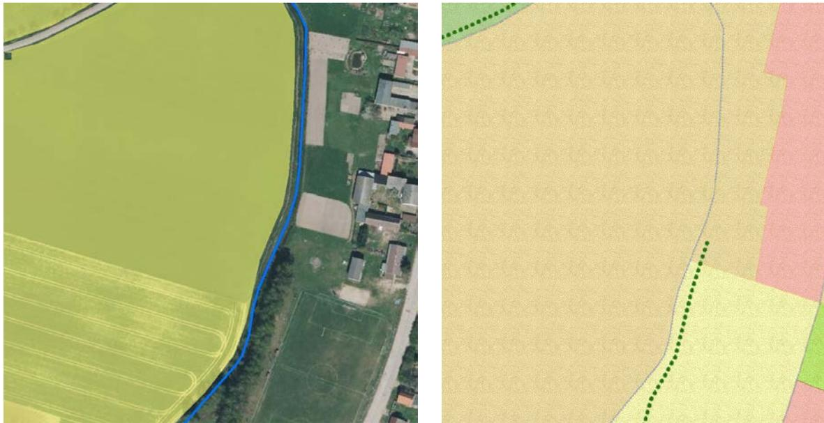
**Abb. 21: Modellierung der Zielfläche nach InVeKoS-Feldblock (links) und nach ATKIS Basis-DLM (rechts), beide im Bezug zur Gewässergeometrie nach ATKIS Basis-DLM (links: blau, rechts: grau)**
