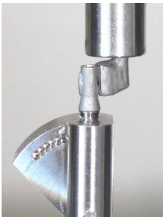
**Abb. 10:** Geschiebe vor dem Zugversuch vollständig gefügt
