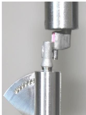
**Abb. 11:** Geschiebe während des Zugversuches
