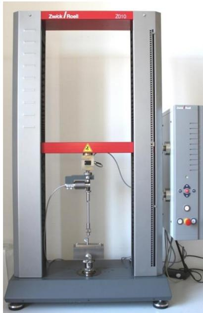
Abb. 3: Universalprüfmaschine Z10, mit welcher die Zugversuche durchgeführt wurden
