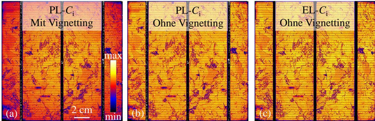
**Abbildung 3.18:** Skalierungsfaktoren  $C_i$  der Lumineszenz aus (a) PL ohne Vignetting-Korrektur, (b) PL mit Vignetting-Korrektur und (c) EL mit Vignetting-Korrektur.
