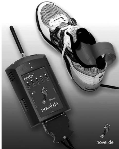
Abb. 2: „Im-Schuh“-Messsystem pedar® (novel GmbH, 2015)
