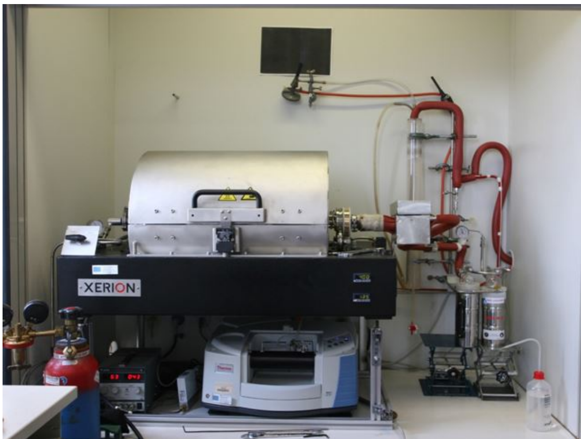
Abb. 2.6: Drehrohrapparatur nach Umsetzung der Optimierungsmaßnahmen.
