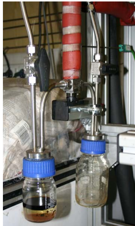
Abb. 3.8: Probenentnahmestation für Flüssigproben nach der Kondensation.
