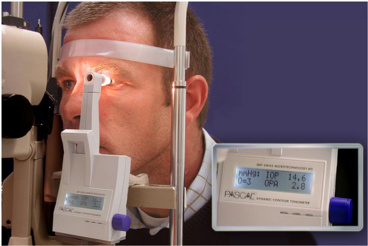
Abbildung 2: Messung des Augeninnendrucks mit einem dynamischen Konturtonometer [Quelle: http://www.ziemergroup.com ]
