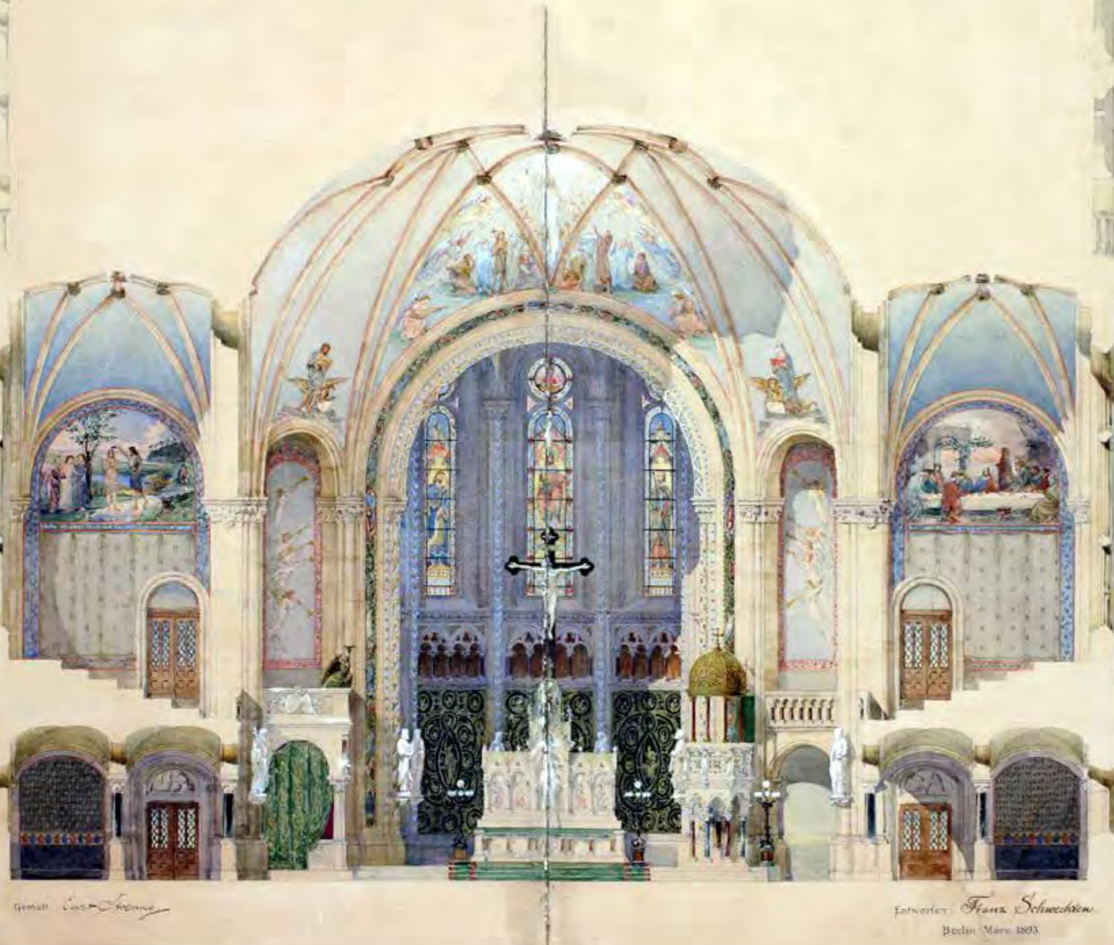
Als Bauwerk zerstört, als Zeichnung lebendig: Querschnitt der Kaiser-Wilhelm-Gedächtniskirche (1893) von Franz Heinrich Schwechten. Quelle: TU Berlin/Plansammlung
