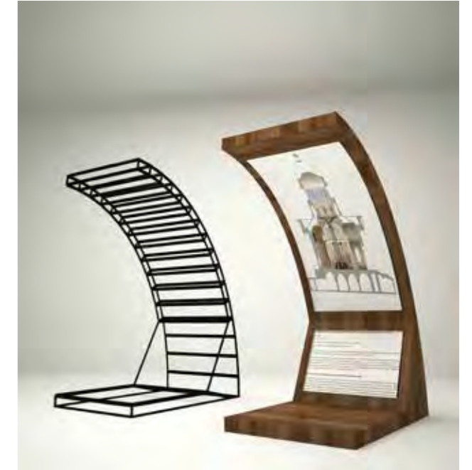
Informationstafeln im Zentralraum: eine Holz-Stahl-Konstruktion
