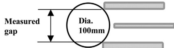
**Abbildung 11-7 Verfahren 2 Abmessung Aussparung/Zwischenraum Gitter**
