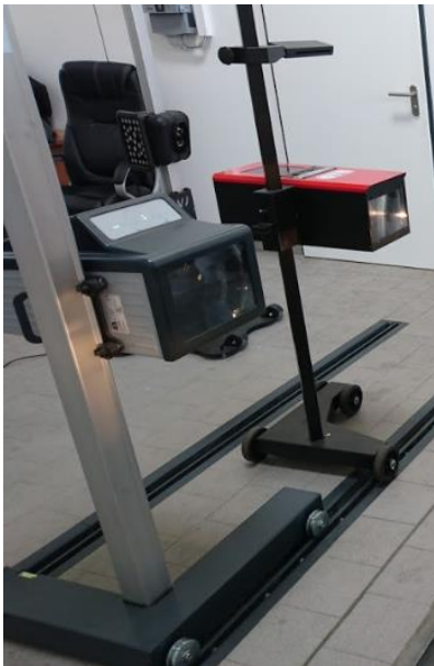
Abbildung 8: Digitales SEP (links im Bild) und analoges SEP (rechts im Bild)
