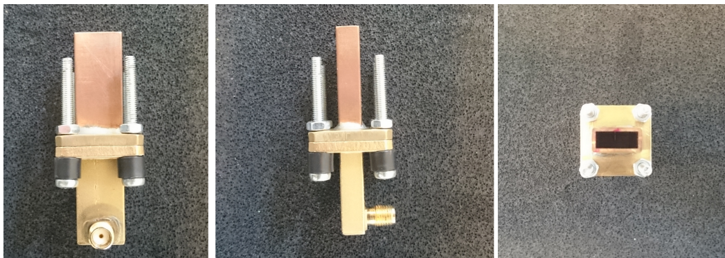
Abbildung 27: Fotografie der offenen Hohlleiterantenne.
