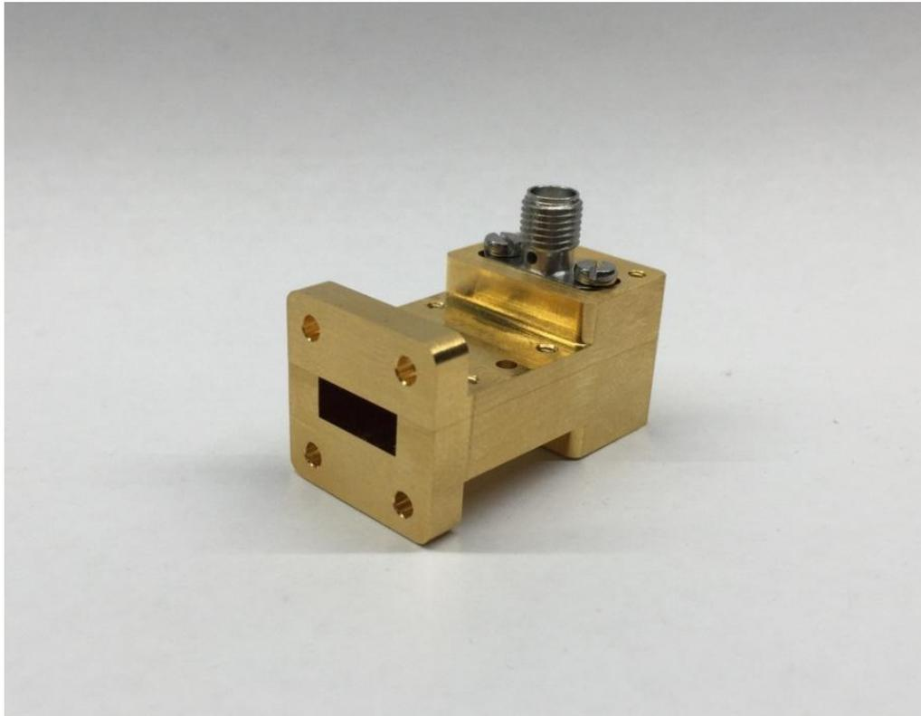
Abbildung 3-26 fertig gestellter Koaxialkabel-Hohlleiter Übergang
