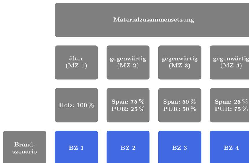
**Abbildung 7.1:** Definierte Brandszenarien zur Untersuchung des Einflusses unterschiedlicher Materialzusammensetzungen von Einrichtungsgegenständen auf die Brandentstehungsphase.
