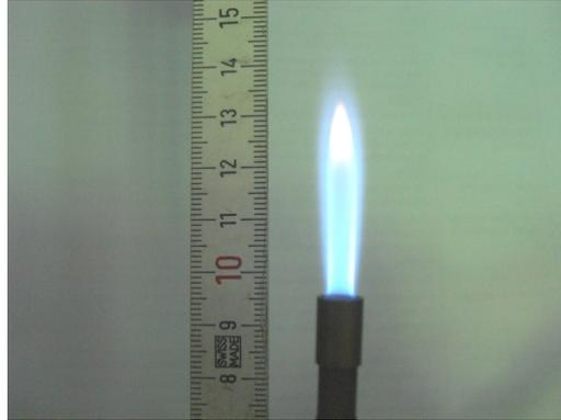
**Abbildung 2.5:** Normierte Gasflamme zur Untersuchung der Entzündbarkeit von Polstermöbeln.
